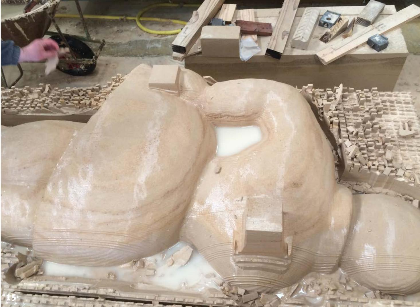
15 | Nach den Kreissägen kommt ein automatischer, computergesteuerter Meißel zum Einsatz, der Bahn für Bahn, Rille für Rille die Form der Figur abfährt und dabei das Material abträgt. Auf dem Foto kann man sehen, wie die hintere Hälfte der Figur, die jetzt ganz rechts auf dem Dach steht, aus dem Steinblock ragt. Noch ist sehr viel Handarbeit nötig, um die Figur an den Ausarbeitungsstand der Modellfigur anzunähern.
